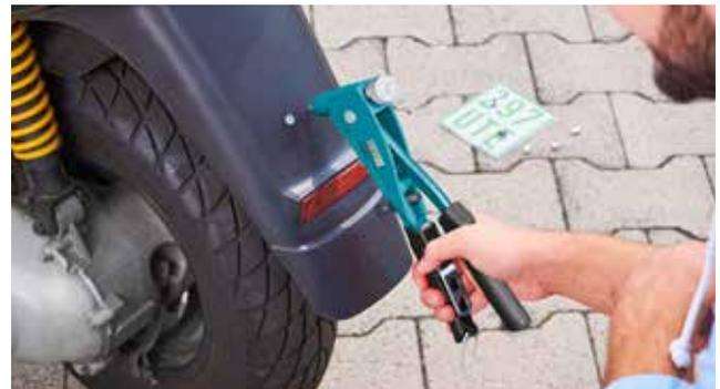
Nummernschilder können durch das Gewinde in der Nietmutter mühelos gewechselt werden
