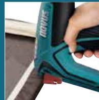
Per **Distanzanschlag** wird eine Klammerreihe parallel auf einer Höhe getackert.
